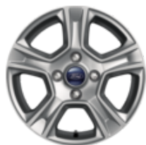
Jantă din aliaj 15" design cu 5 spițe, argintiu 6 x 15", offset 37,5, pentru anvelope de 195/60 R15
